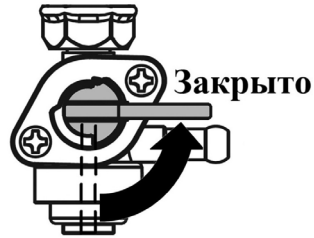
Рис. 12 Топливный кран закрыт
