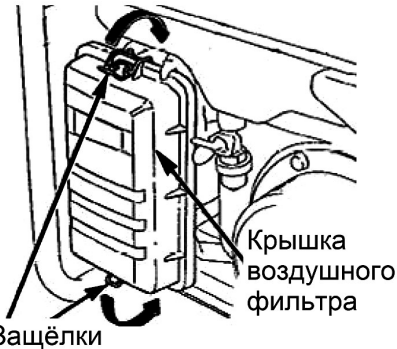
Рис. 14 Снятие крышки воздушного фильтра
